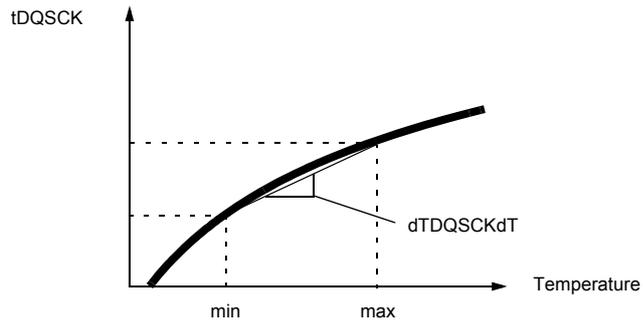
$$dTDQSCKdT = |tDQSCK(T_{oper,max}) - tDQSCK(T_{oper,min})| / |T_{oper,max} - T_{oper,min}|$$
