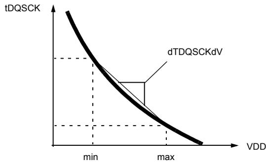
$$dTDQSCKdV = |tDQSCK(VDD,max) - tDQSCK(VDD,min)| / |VDD,max - VDD,min|$$
